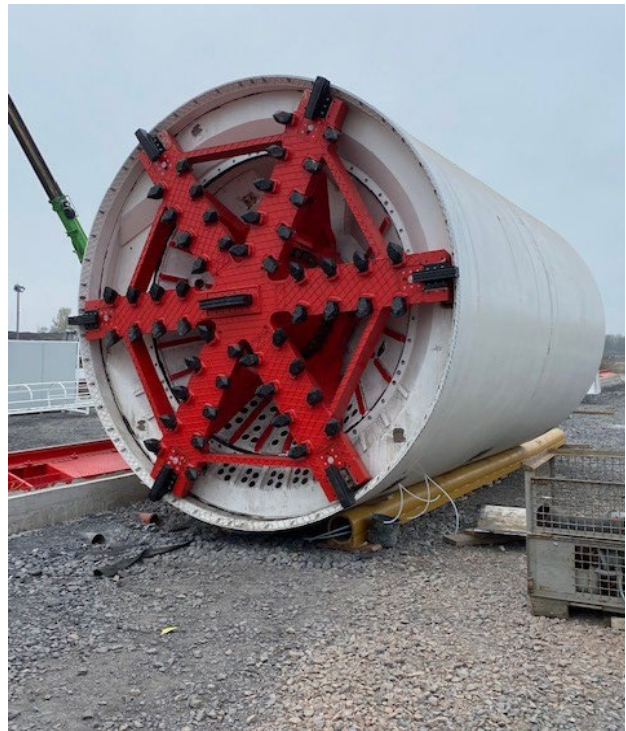
Bild 9.4 – Tunnelbohrmaschine mit Schneidrad (Quelle: Bezirksregierung Arnsberg)
