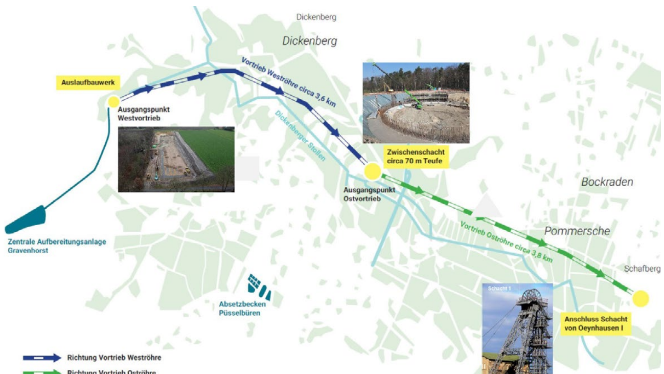
Bild 7.1 – Trassenverlauf Grubenwasserkanal Ibbenbüren (Quelle: RAG AG)
