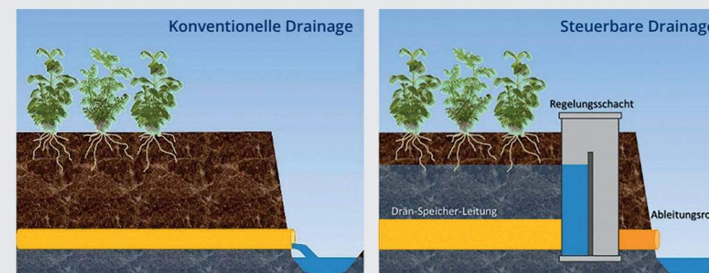
Abbildung 7: Vergleich einer konventionellen Drainage mit dem Funktionsprinzip einer steuerbaren Drainage.
