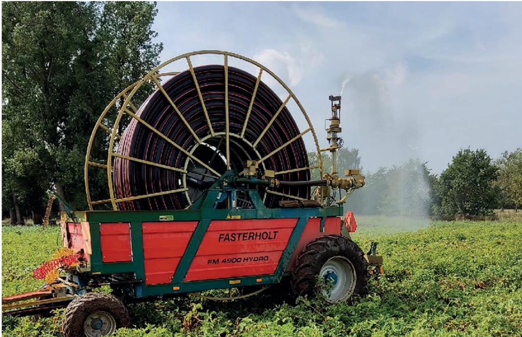
Abbildung 14: Der „Raindancer“ der Fa. Fasterholt weist eine deutliche Effizienzsteigerung gegenüber herkömmlichen Starkregnern auf: Mittels Sektorsteuerung werden die Anschläge des Regners anhand der Feldgrenzen und der Wurfweite automatisch angepasst (Quelle: Keutmann/LWK).
