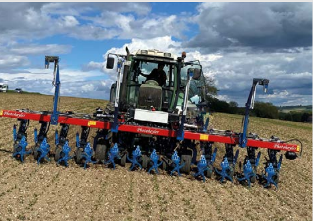
Bild 1: mit Kamera ausgestattete Hacke zur Unkrautbekämpfung im Bestand
