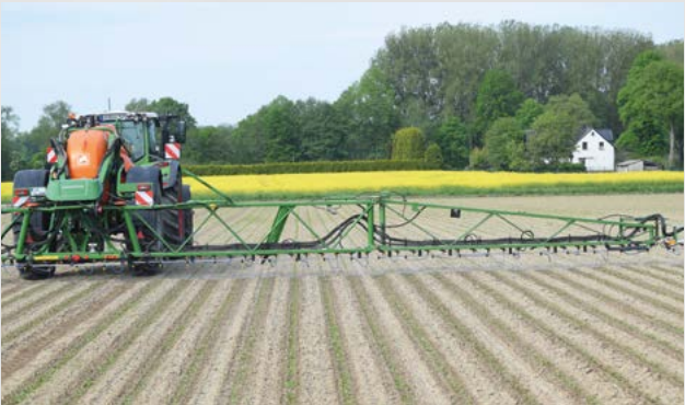
Bild 4: Beispiel zur Reduktion der Pflanzenschutzmittel-Anwendungsintensität auf der Fläche: Bandspritzung in einem Zuckerrübenbestand
