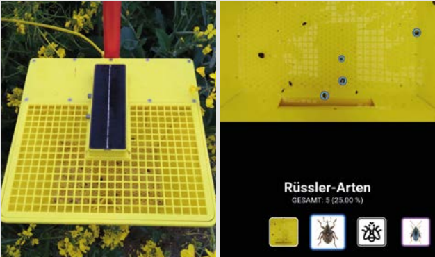
Bild 3: Digitale Gelbfangschale „Magic Trap“. KI-basierte Auswertung der gefangenen Insekten. Ergebnisse können auf dem Smartphone über eine App abgerufen werden
