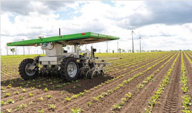
Bild 2: „Farmdroid“ (Aussaat & Hacken)
