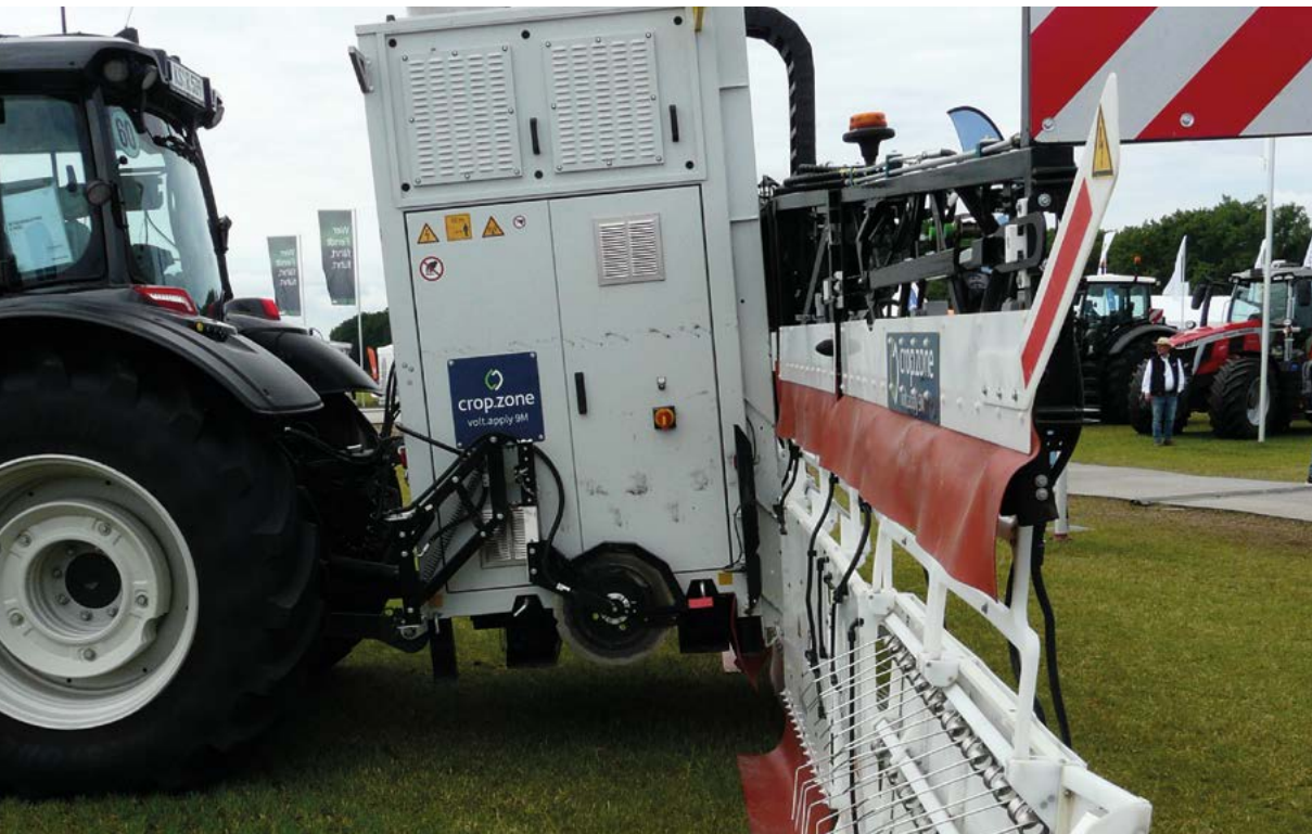
Bild: „Crop-Zone“ Elektro- Weeding mit Elektrolytlösung
