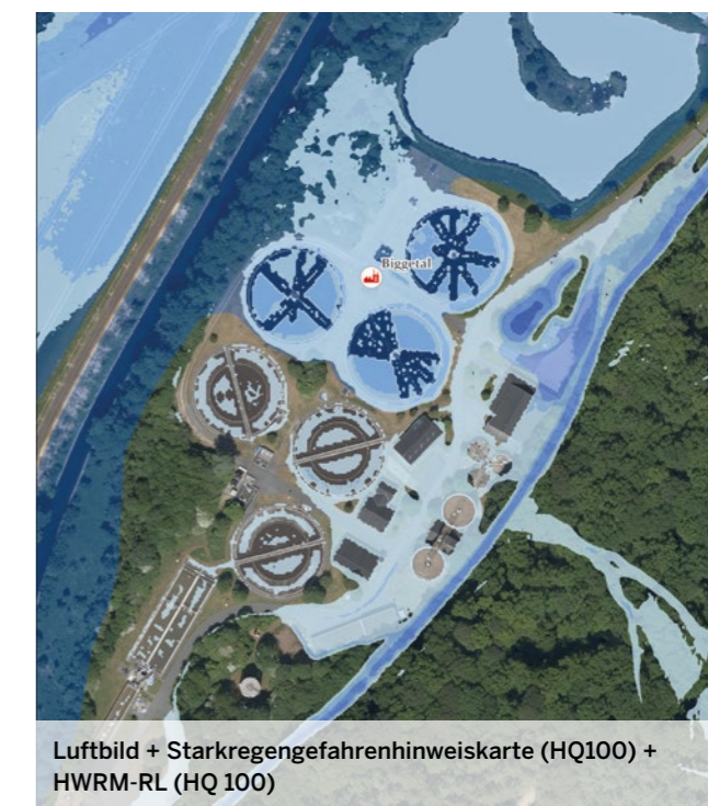
Abbildung 11.2 Betroffenheit der Kläranlage Biggetal bei einem HQ100 Ereignis und zusätzlich einem Starkregenereignis (LANUV, 2023)
