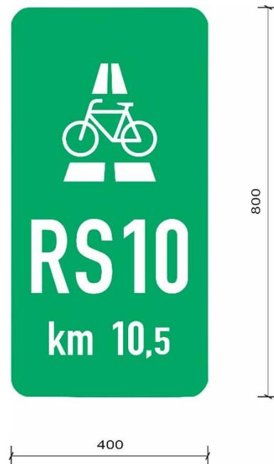
Abb. 3-42: Streckenkilometrierung entlang des RS10
