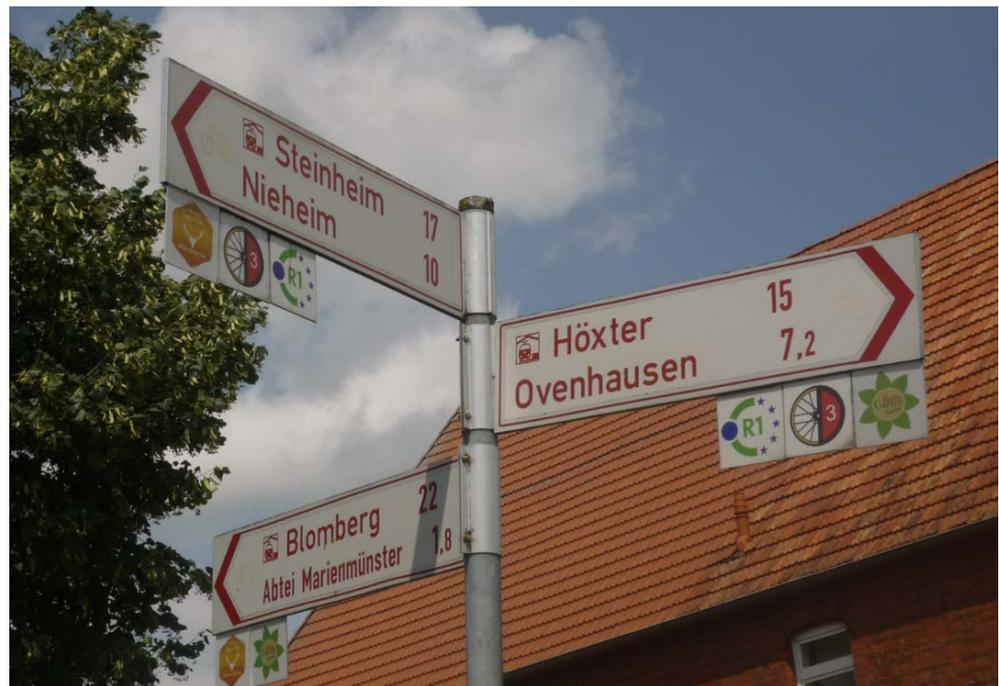
Abb. 3-23: Beispiel für die additive Anordnung von Routeneinschüben unter ziel-orientierter Wegweisung (hier: Pfeilwegweiser) (Quelle SVK)
