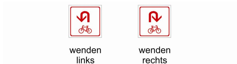
Abb. 3-21: Sonderform der Gestaltung eines Zwischenwegweisers (Standort vor dem Wechsel der Straßenseite o.ä.)
