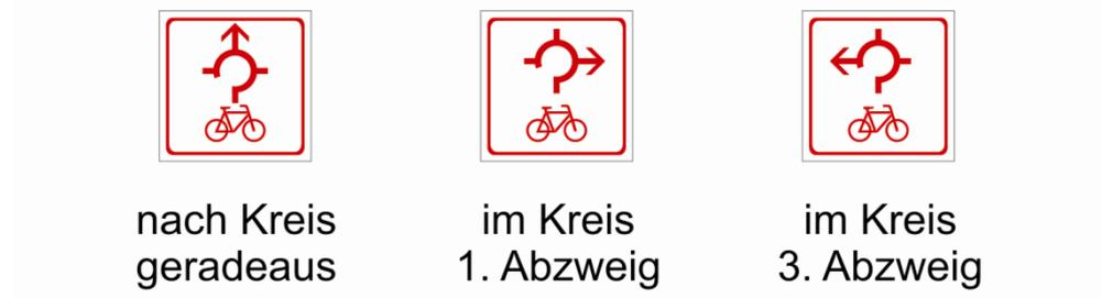
Abb. 3-20: Sonderform der Gestaltung eines Zwischenwegweisers an Kreisverkehren (Standort vor der Zufahrt in den Kreisverkehr)
