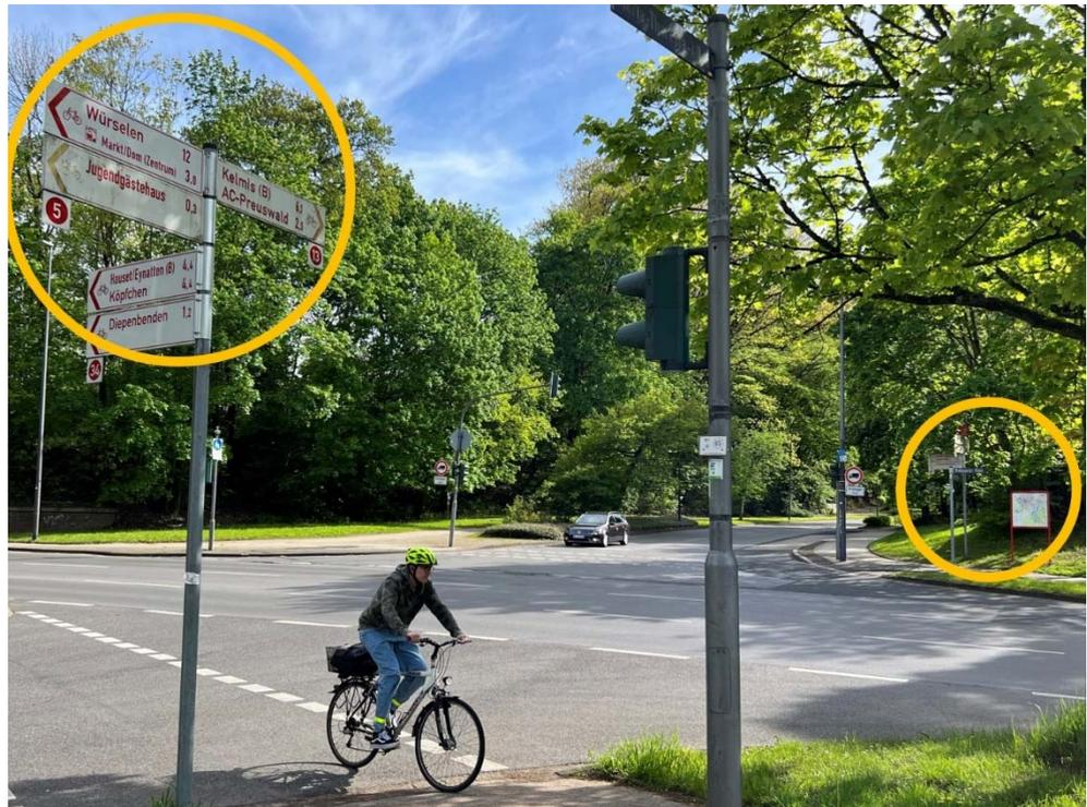
Abb. 3-31: In Abhängigkeit von der Fahrbahnbreite kann es aus Gründen der Lesbarkeit sinnvoll sein, jeweils einen Wegweiser auf jeder Straßenseite zu installieren. (Quelle: SVK)
