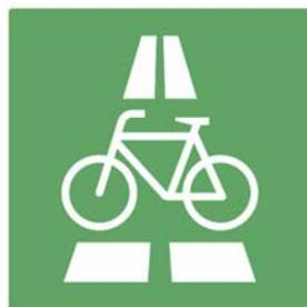
Abb. 3-43: Piktogramm zur Kennzeichnung von Radschnellverbindungen
