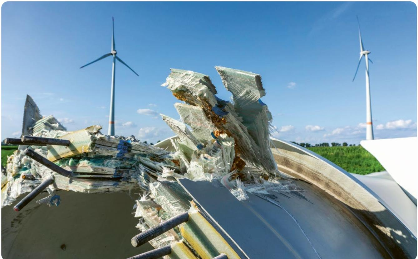
Repowering bei Issum: Das 23 Jahre alte Rotorblatt besteht u. a. aus Verbundwerkstoffen (GFK, CFK).
