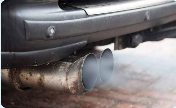
Doppelauspuff eines älteren PKW mit Dieselmotor und hoher Feinstaubbelastung
