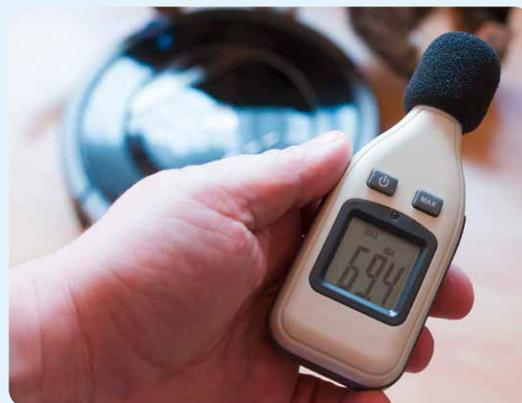
Lautstärkemessung eines Staubsaugerroboters
