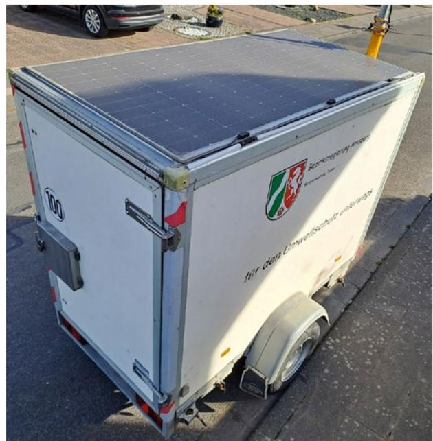
**Bild 5.1** – Mobile Lärmmessstation mit neu installierter PV-Anlage (Quelle: Bezirksregierung Arnsberg)
