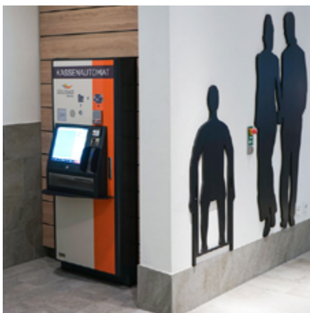
Barrierefreier Automat in einem Schwimmbad. Display und alle Funktionen sind auch sitzend nutzbar.
