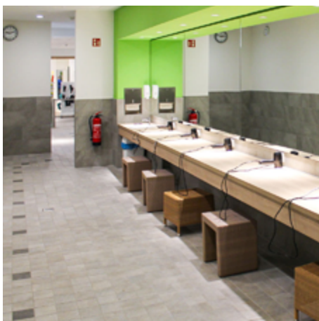
barrierefreier Föhnbereich: hell, unterfahrbare Ablage mit Sitzhocker, tiefer Spiegel, Leitstreifen
