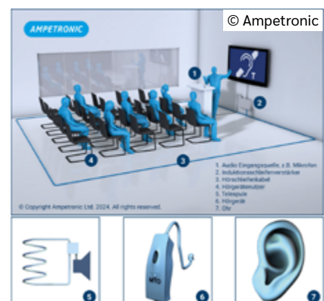
Funktion einer Induktionsschleife – der Ton aus dem Mikrophon wird direkt auf das Hörgerät übertragen.
