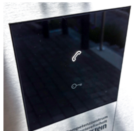
Detail einer Gegensprechanlage: aktive optische Anzeige für die Hörbereitschaft leuchtet.
