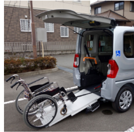
Platzbedarf eines PKW mit Heckeinstieg für einen Rollstuhl
