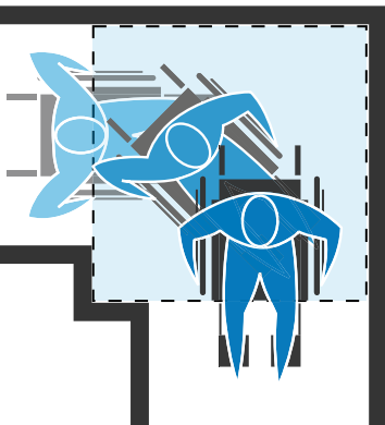
Rangierfläche eines Rollstuhls bei einem 90-Grad-Richtungswechsel
