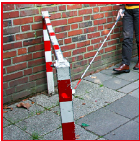
Nicht tastbare Absperrschranke mitten auf einem Gehweg: die blinde Person droht, gegen die Schranke zu laufen
