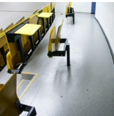
Rollstuhlplätze mit Klapptischen auf der obersten Ebene eines Hörsaals mit genügend Platz zum Passieren
