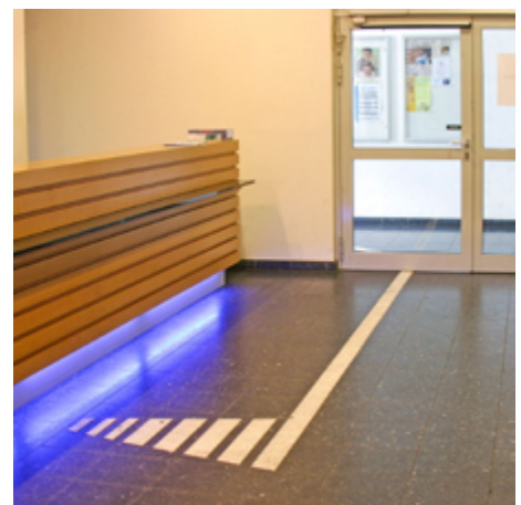
Der kontrastreiche Leitstreifen führt direkt vom Haupteingang zum markant beleuchteten Infotresen.
