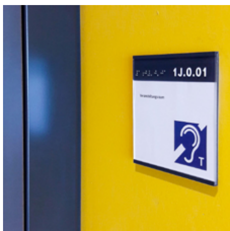
Türschild eines Versammlungsraumes mit Hinweis auf die Induktionsschleife (sogenannte „T-Spule“)
