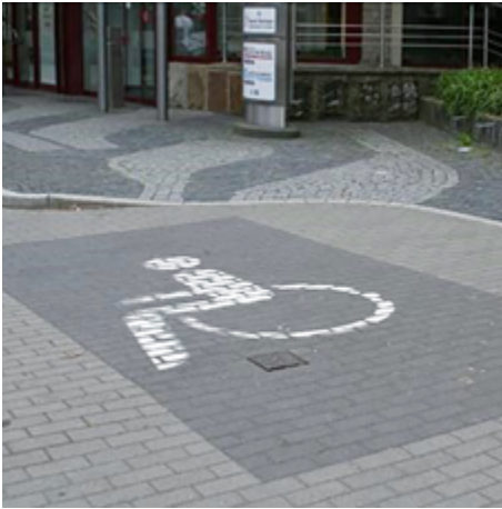
Barrierefreier PKW-Stellplatz mit Bordsteinabsenkung vor dem Eingang eines Bürgerbüros
