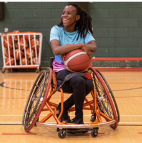
Sport-Rollstuhl – durch die schräg angeordneten Räder wesentlich breiter als Standard-Rollstühle
