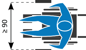
Durchfahrtsmaß eines Rollstuhls an einer Engstelle
