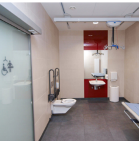
Toilette für alle mit Decken-Lifter, höhenverstellbarer Klappliege und Logo an der Schiebetür
