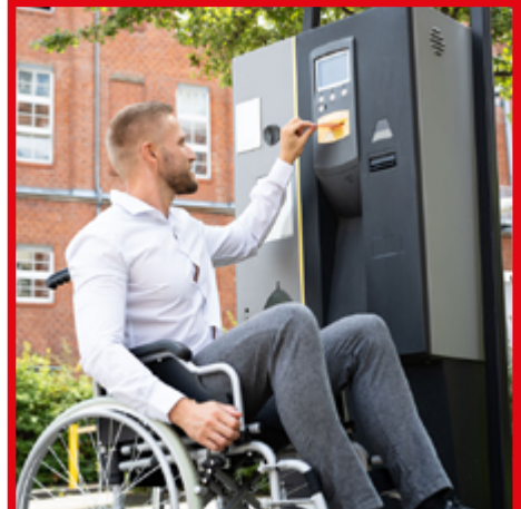
Bedingt barrierefreier Parkautomat: die Bedienelemente und das Display sind zu hoch.
